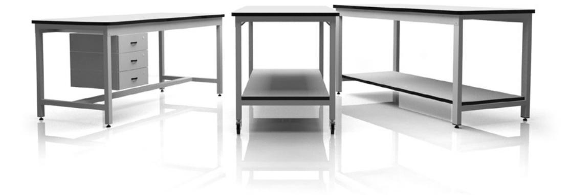
I tavoli tecnici della linea **ECO** sono pratici e robusti. Hanno una struttura in **lamiera metallica** con verniciatura a polvere di colore **grigio RAL7035**. La struttura portante è in tubi con **sezione rettangolare 40x40mm**. I piani di lavoro sono spessi 27mm con bordi in **ABS nero**, hanno dimensione **1800x800mm** con **angoli arrotondati**.
