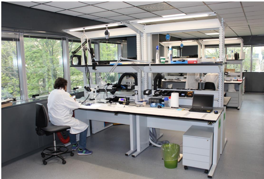
8 banchi da lavoro della linea **KE HIGH** contrapposti a formare isole da 4 banchi ciascuna.
