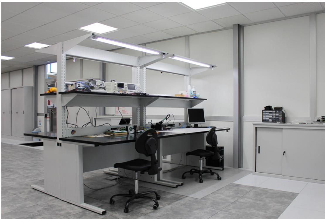
Isola di lavoro composta da quattro banchi **KE HIGH** in configurazione ESD.
